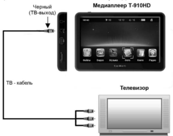
1. Один штекер ТВ-кабеля подключите в разъем плеера (ТВ-выход).
