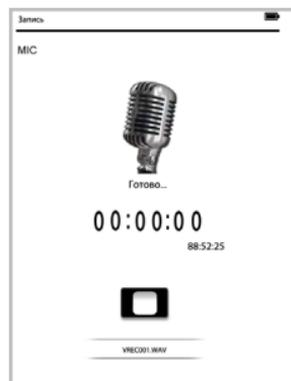
Всем файлам, записываемым со встроенного микрофона, автоматически присваивается имя вида **VREC\*\*\*.wav**.
