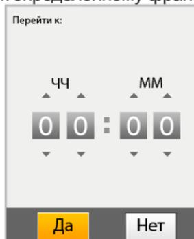
Для перемещения между полями используйте кнопки **▲/▼**. Установите нужный временной интервал для перехода при помощи кнопок **◀▶**, кнопками **▲/▼** выберите “**Да**” и нажмите кнопку **M**.
