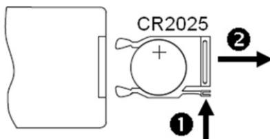
Отсек легко отсоединится от корпуса пульта ДУ. Установите в отсек новую батарею типа CR2025 так, чтобы сторона с маркировкой “+” (плюс) была сверху.
