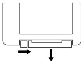
Отсек легко отсоединится от корпуса пульта ДУ. Установите в отсек новую батарею типа CR2025 так, чтобы сторона с маркировкой "+" (плюс) была сверху.
