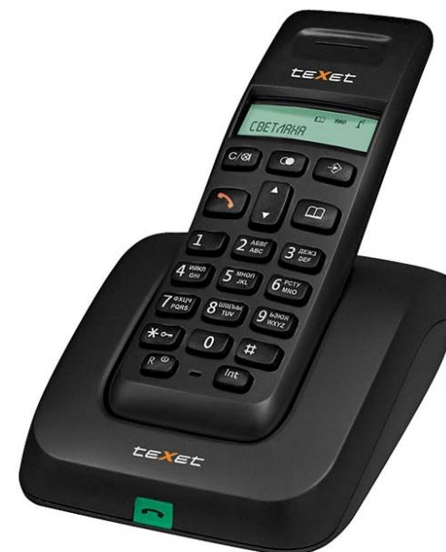
Модель TX-D5305A относится к бюджетной категории. К стандартному набору функций (повтор номера, регулировки громкости, поиск трубки, пауза и т.д.) имеется **российский автоматический определитель номера**, русифицированное меню и записная книжка на 50 имен и номеров. Поиск номера абонента в записной книжке реализуется по первой букве имени.
