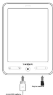
Алғашқы пайдалану алдында аккумуляторлық батареяны толық зарядтаңыз. Аккумуляторлық батарея толық зарядталғанда зарядтау үдерісі автоматты түрде тоқтайтын болады.
